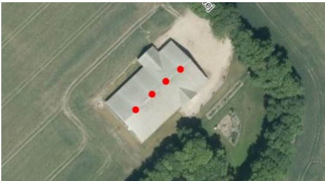
Figur 2: Placering af ventilationsafkast på staldanlægget
